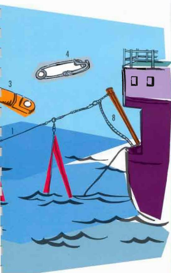
**П**РИКРЕПИТЕ свинцовый вертлюг [2] к одному концу 150-метрового линя [1] - это предохраняет конец линя от износа и имеет достаточный вес, чтобы лень при постановке оттягивался на безопасное расстояние от кормы и чтобы создалось достаточное напряжение при буксировке, необходимое для поддержания правильного положения линя при поперечном ветре.
