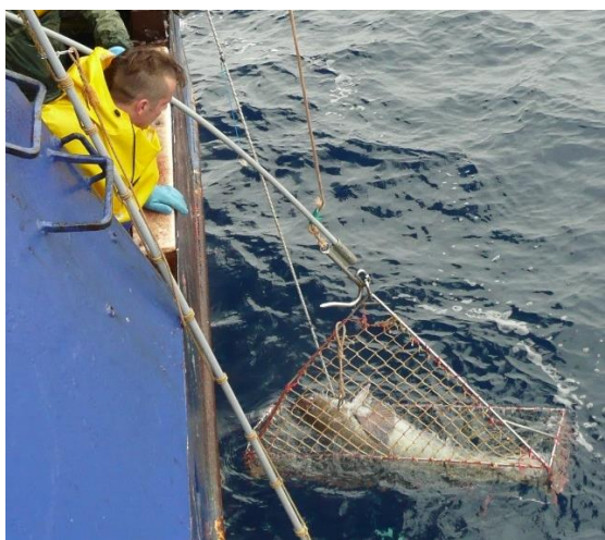
Рис. 7. Подъемные приспособления для подъема рыбы на борт
