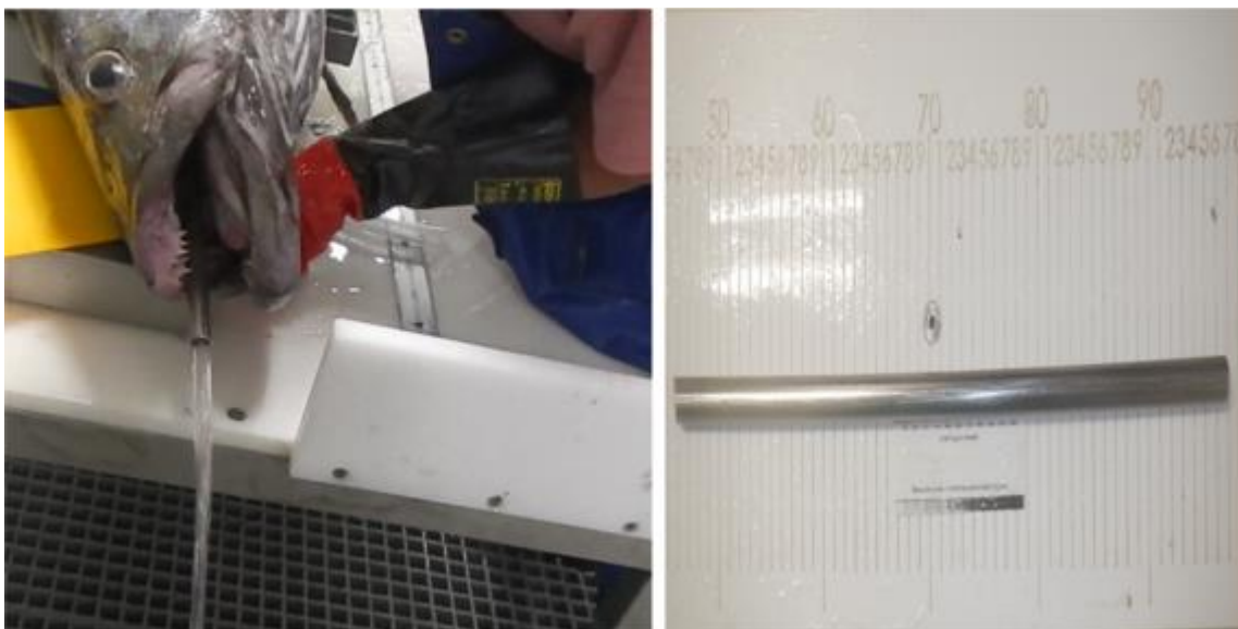
Рис. 13: Стальная трубка для оттока воды из желудка перед взвешиванием. Фото: Энди Смит (CAPFISH).
