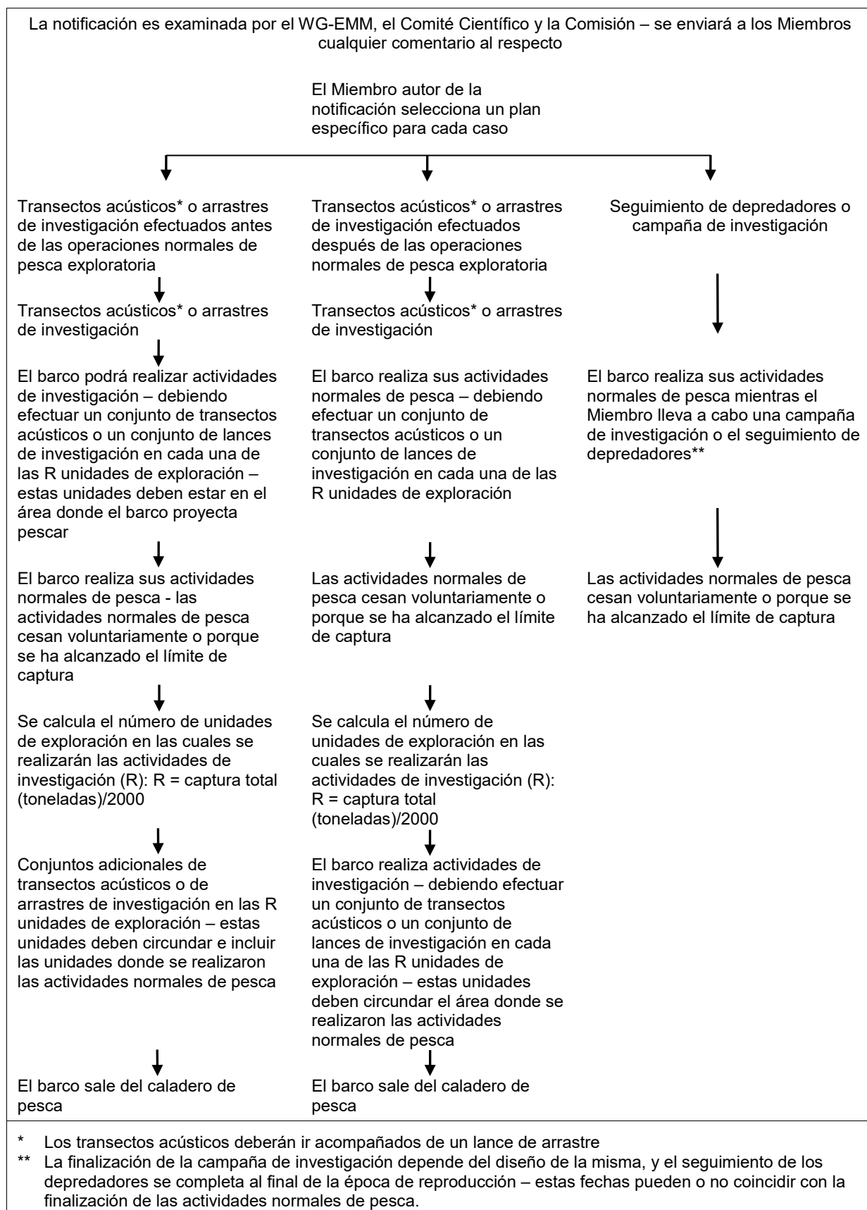
Figura 1: Descripción esquemática de las principales actividades a ser realizadas durante la planificación y ejecución de las pesquerías exploratorias de kril.
