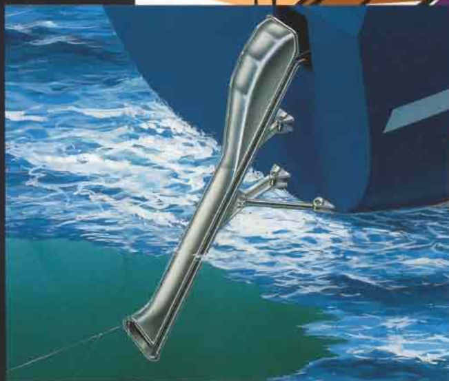
Un conducto fabricado por 'O. Mustad & Son A. S.' para el calado submarino del palangre por la popa
