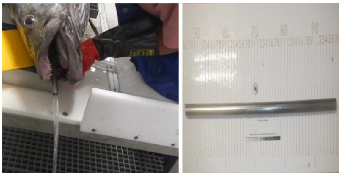
Figura 13: tubo de acero para drenar el agua del estómago de un pez antes de su pesado. Foto: Andy Smith (CAPFISH).
