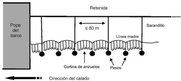
Configuración típica del sistema de palangre (espinel) artesanal
