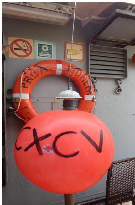
Figura 2. Radioboya A4 A5, identificación y ubicación línea de pesca (BP Proa Pioneer).
