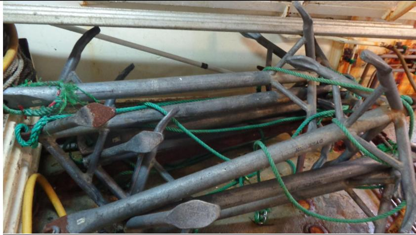
Figura 3. Ancla tipo rezón de tres patas anclaje línea de pesca (BP Proa Pioneer).
